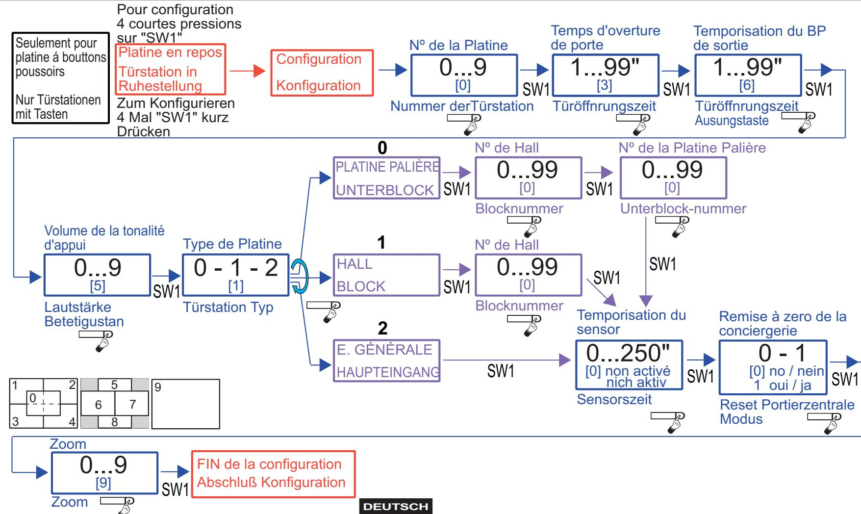
1. Durch 4-maliges Drücken von SW1 gelangt man in den Konfigurationsmodus. Der Verstärker gibt die Meldung "KONFIGURATION" aus und der Vorgang wird gestartet. Siehe Diagramm. Um den Konfigurationsmodus zu verlassen, 5 Sekunden lang SW1 drücken. Nach Ablauf von 30 Sekunden ohne Eingabe, wird der Modus automatisch verlassen.
